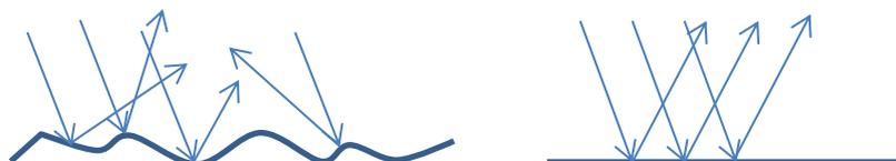
L'effet métallique ne peut pas être amélioré en augmentant l'épaisseur du film d'encre. Cela entraîne simplement des problèmes d'impression tels que des montées en épaisseur, un mauvais séchage, une très faible résistance aux frottements.
